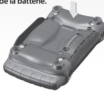
**4** Fermez le compartiment de la batterie. Réinstallez le volet et resserrez les rabats.
