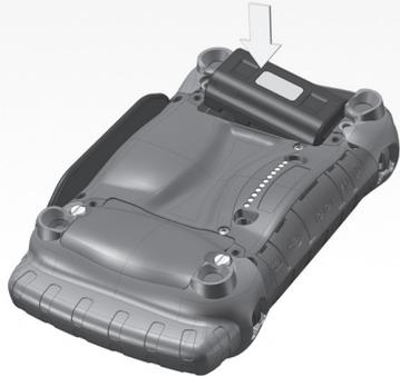
**3** Insérez le bloc de batterie dans le compartiment.
