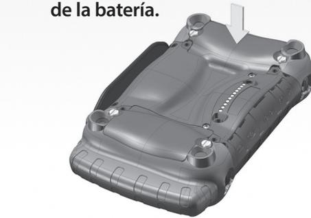
**4** Cierre el compartimento de la batería. Vuelva a colocar la tapa y apriete los seguros.
