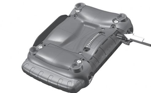
**5** Conecte el cargador al dispositivo Mesa. Siga las instrucciones de la pantalla. Cargue de 4 a 6 horas.
