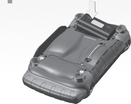
**3** Coloque la batería en el compartimento.
