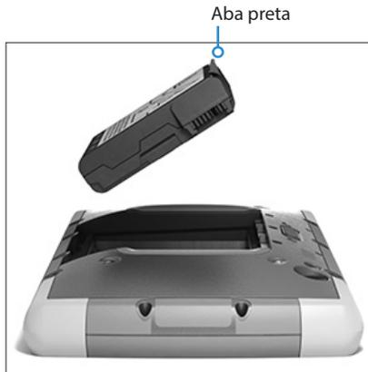
4. Recoloque a tampa e pressione-a até a trava se encaixar na posição travada.
