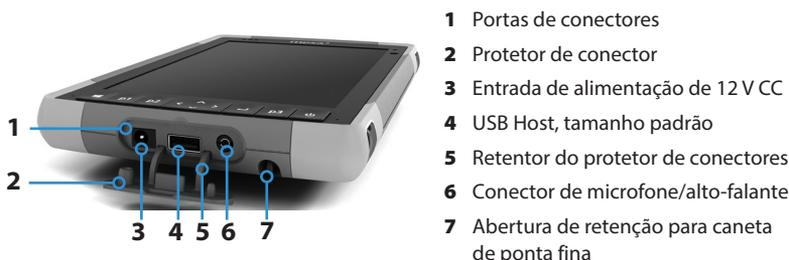
O protetor de conectores é removível e substituível. Consulte o seu representante de vendas caso precise de um novo. Para removê-lo, puxe e o remova das portas, em seguida puxe os retentores de borracha curvos para fora dos orifícios em que se encontram. Recoloque-o inserindo os retentores de borracha curvos de volta nos orifícios.
