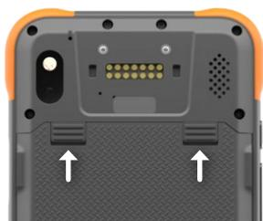
**⚠ PRECAUCIÓN:** Los pestillos de la tapa de la batería deben estar en la posición bloqueada para que funcione la conexión NFC.
