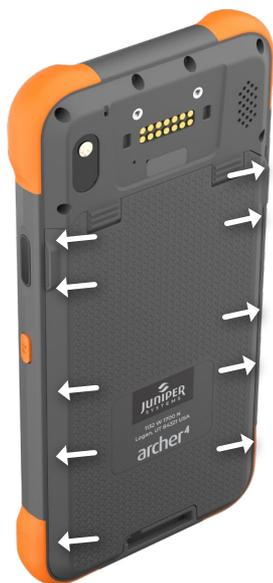
4. Deslice las cerraduras de la tapa de la batería a la posición de bloqueo.
