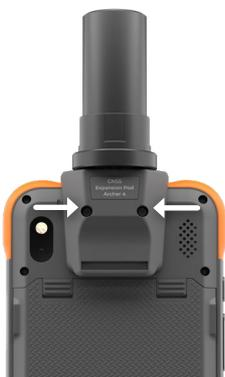
4. Passe a alça de mão através do laço de montagem na parte inferior da expansão GNSS do submedidor, se desejado.
