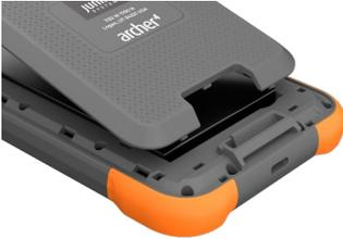
3. Arbeiten Sie von der Unterseite des Deckels in Richtung der Deckelverschlüsse und drücken Sie die Laschen an den Seiten des Deckels in Position.
