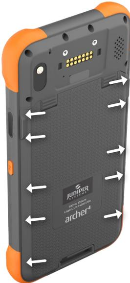
4. Schieben Sie die Verriegelungen des Akkufachs in die verriegelte Position.
