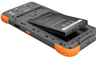
2. Führen Sie die drei Laschen des Akkufachs in die Schlitz am unteren Befestigungsbügel des Handriemens ein.
