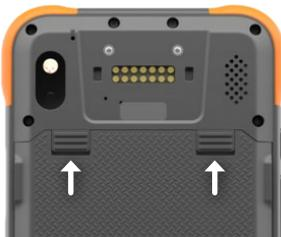
**! VORSICHT:** Damit NFC funktioniert, müssen die Verriegelungen des Akkufachs in der verriegelten Position sein.
