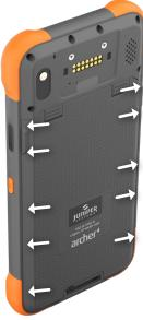
4. Faites glisser les verrouillages du couvercle du compartiment de la batterie en position de verrouillage.
