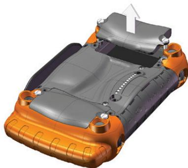
2. Coloque la(s) batería(s) de iones de litio en los compartimentos. Asegúrese de que los conectores de la(s) batería(s) están alineados con los conectores dentro de los compartimentos.
