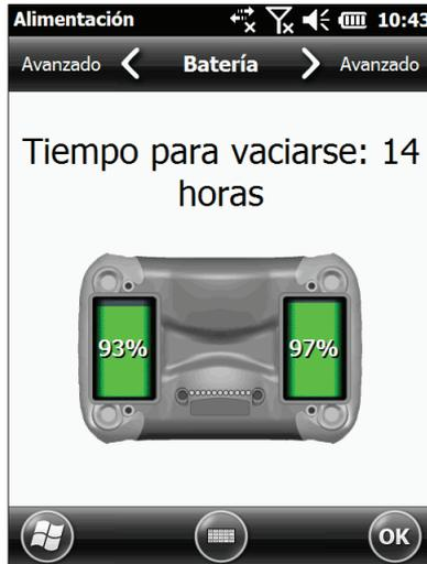
Vaya a la pantalla de configuración Avanzado para seleccionar durante cuánto tiempo debe permanecer activado el dispositivo Mesa cuando no se está utilizando. Como se menciona en “Ajustar la retroiluminación,” la atenuación de la retroiluminación de la pantalla ahorra batería. Las radios también pueden utilizar mucha alimentación. Puede ahorrar energía si las inhabilita cuando no se estén utilizando desde la pantalla de la página principal o desde Inicio > Configuración > Conexiones.
