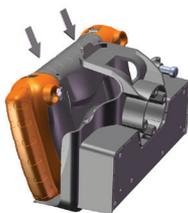
3. Presione el dispositivo Mesa para fijarlo al acoplamiento portátil. El seguro superior encajará en su sitio.
