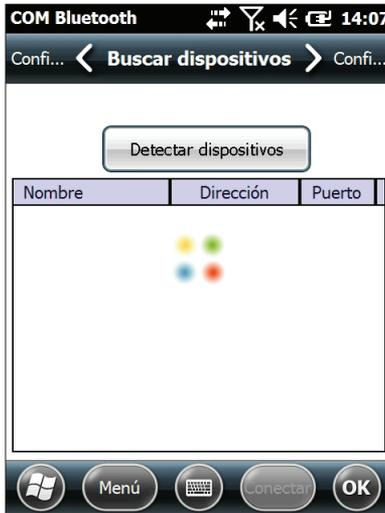
2. Aparecerá la lista de los dispositivos detectados. Seleccione de la lista el dispositivo al que desee conectarse y puntee sobre *Conectar*. Se asignará un puerto COM automáticamente al dispositivo. Puede cambiarlo a otro puerto COM.
