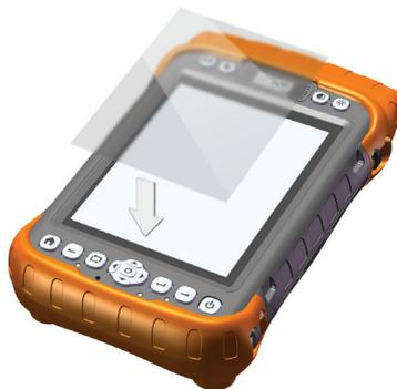
3. Utilice la tarjeta de instalación para extraer las burbujas de aire (puede tardar varios días en extraer las burbujas de aire).
