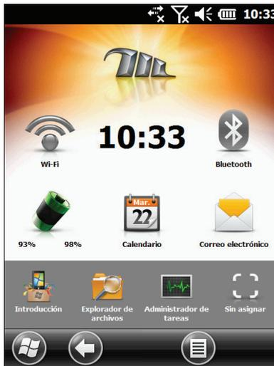
2. Puntee y mantenga el icono Wi-Fi para ir al panel de control de la red Wi-Fi. Cuando el dispositivo Mesa completa el escáner, aparece una lista de redes disponibles y sus potencias en la pantalla Redes inalámbricas.
