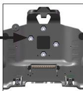
2. Desde la parte posterior del acoplamiento, alinee una de las bases de instalación RAM con los agujeros para tornillos.
