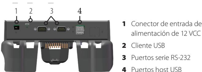
1. Conector de entrada de alimentación, 12 VCC para la entrada de alimentación y carga de la batería: este conector proporciona alimentación al acoplamiento portátil y al dispositivo Mesa. No es posible acceder al puerto de alimentación del dispositivo Mesa cuando este se encuentra en el acoplamiento portátil.
