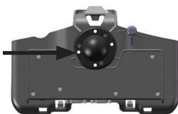
3. Inserte los cuatro tornillos en estos agujeros, atorníllelos completamente y apriételes.
