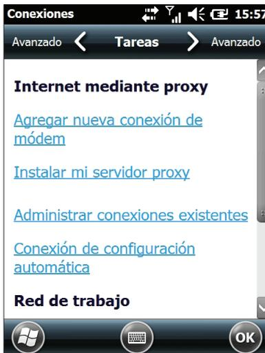
Seleccione "Conexión de configuración automática". Aparecerá el nombre del proveedor. Puntee en *Siguiente*. Se mostrará una barra de progreso en la pantalla siguiente mientras se define la configuración de Internet.
