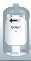
Appuyez sur le volet du compartiment de la batterie. Faites glisser le loquet vers la gauche pour le verrouiller en place.
