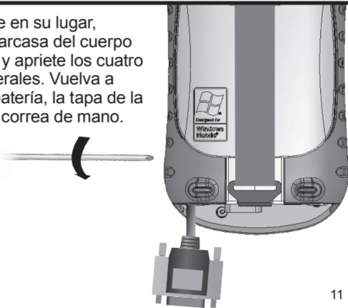
4. Conecte el conector del sensor en el puerto serie de 9 patas o en el puerto host USB.
