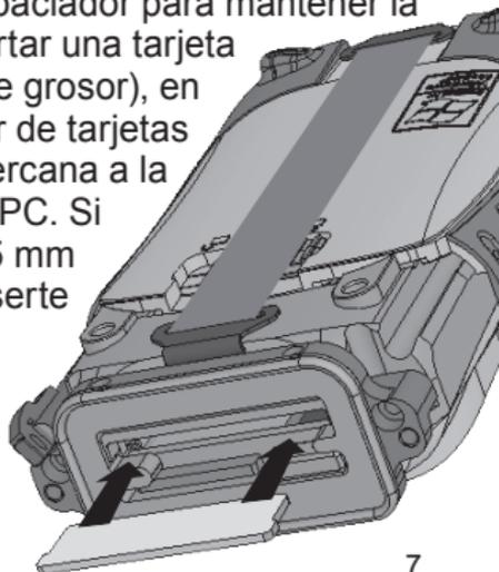
5. Una vez que haya introducido la tarjeta o tarjetas, apriete los cuatro tornillos laterales pequeños hasta que la parte superior de cada tornillo quede a la misma altura que la junta exterior.
