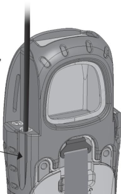
8. Drehen Sie die Schrauben der Kappe fest. Damit die Verbindung zwischen der Kappe und dem Field PC einwandfrei dicht ist, drehen Sie die Schrauben über den ersten spürbaren Widerstand hinaus noch um eine  $\frac{1}{4}$  bis  $\frac{1}{2}$  Drehung fester.
