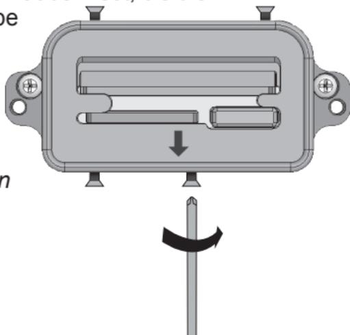
6. Wenn Sie eine Kamera-SD-Karte eingesetzt haben, polstern Sie die Kappe im oberen Bereich innen mit großen Schaumstoffstücken aus, damit die Kamera sicher und unbeweglich im Steckplatz gehalten wird. Füllen Sie die Kappe mit einer ausreichenden Menge Schaumstoff aus, so dass, wenn Sie die Kappe mit leichtem Druck wieder auf den Field PC aufsetzen, zwischen der Kappe und dem Field PC ein 6 mm breiter Spalt übrig bleibt. Dieser Spalt schließt sich, wenn Sie die Kappe in Schritt 8 befestigen.
