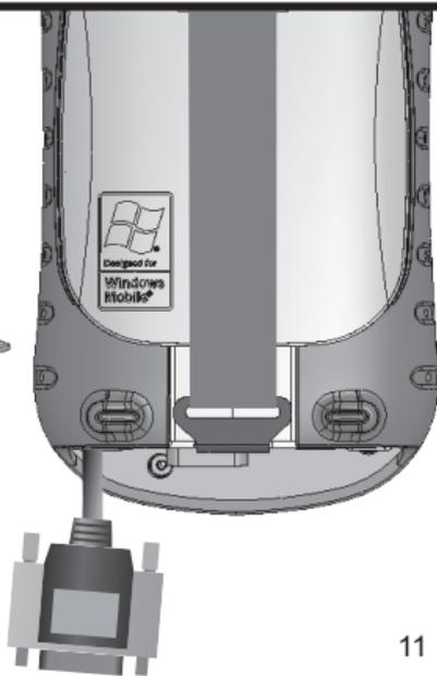
4. Verbinden Sie den Sensorstecker mit dem 9-poligen seriellen Anschluss oder dem USB-Host-Anschluss.
