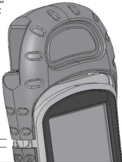
3. Drehen Sie die Schrauben der Kommunikationskappe wieder fest. Damit die Verbindung zwischen der Kappe und dem Field PC einwandfrei dicht ist, drehen Sie die Schrauben über den ersten spürbaren Widerstand hinaus noch um eine  $\frac{1}{4}$  bis  $\frac{1}{2}$  Drehung fester.
