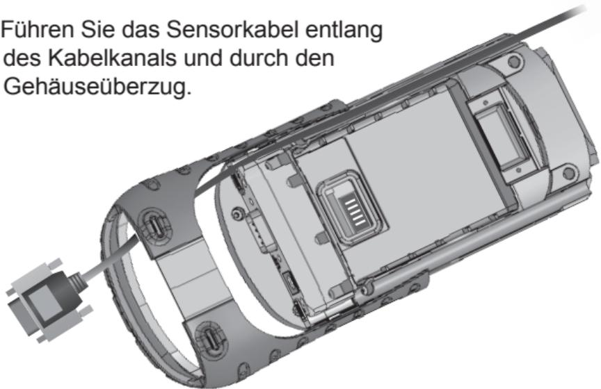
3. Wenn das Kabel korrekt verlegt ist, schieben Sie das Gehäuse wieder zusammen und drehen Sie die vier seitlichen Schrauben wieder fest. Setzen Sie den
