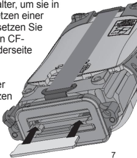
5. Nachdem Sie die Karte(n) eingesetzt haben, drehen sie die vier seitlichen Schrauben fest, bis die Oberseite jeder Schraube mit der Außenseite der Dichtung bündig ist.
