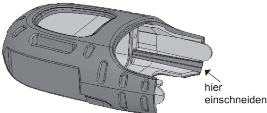
7. Schieben Sie die Erweiterungskappe auf den Field PC und drücken Sie das Sensorkabel durch den vorgenommenen Einschnitt, so dass das Kabel den Kabelschacht am oberen Ende verlässt.
