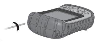
2. Insira o seu cartão. Para fixar o seu cartão na ranhura, amorteça-o colocando pedaços pequenos ou médios de esponja no interior da parte superior do acessório. Insira no acessório esponja suficiente para que, quando fizer deslizar novamente o acessório para dentro do Field PC, aplicando pouca pressão, permaneça um espaço de 6 mm entre o acessório e o Field PC, conforme apresentado. espaço de 6 mm
