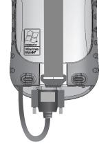
Certifique-se de que a placa adaptadora de proteccão se encontra correctamente instalada.
