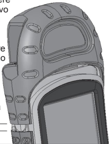
3. Serrare le viti del cappuccio di comunicazione finché sono saldamente in posizione. Per fissare correttamente il cappuccio, applicare un ulteriore  $\frac{1}{4}$  -  $\frac{1}{2}$  giro dopo che le viti diventano difficili da girare.
