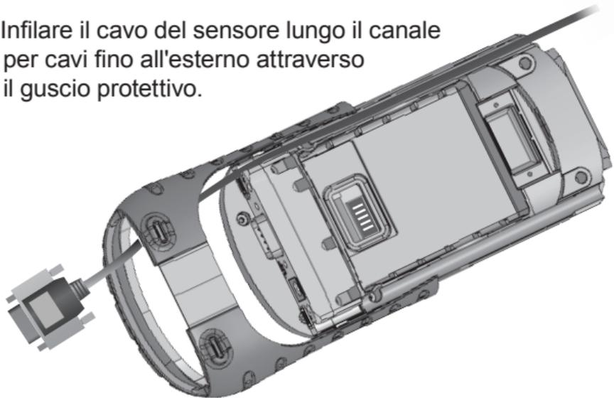
3. Con il cavo in posizione, far scorrere il guscio protettivo in posizione e serrare le quattro viti laterali. Ricollocare il pacco batteria, lo sportello della batteria e la cinghia per mano.
