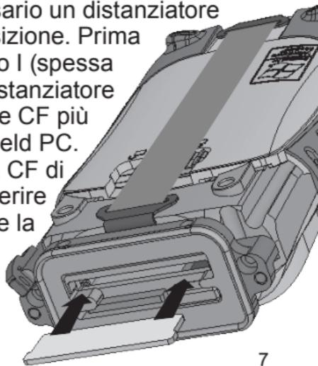
5. Una volta inserita/e la/e scheda/e, serrare le quattro viti laterali piccole finché la parte superiore di ciascuna vite è a livello con l'esterno del pezzo di guarnizione.
