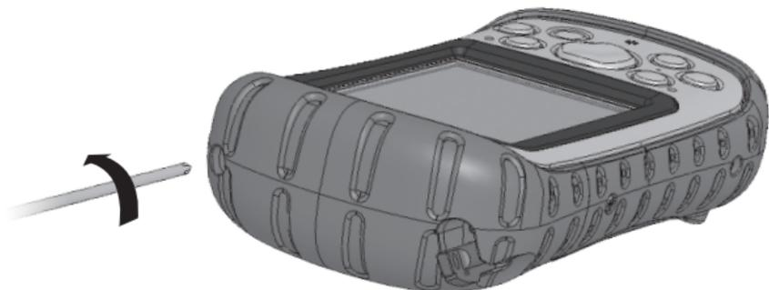
2. Inserire la scheda. Per mantenere saldamente la scheda nel relativo slot, imbottirla collocando pezzi di spugna di dimensioni piccole o medie, all'interno della parte superiore del cappuccio. Inserire sufficiente spugna nel cappuccio in modo tale che, quando si fa scorrere nuovamente il cappuccio sul Field PC, esercitando poca pressione, rimanga uno spazio di 6 mm tra il cappuccio e il Field PC, come mostrato.
