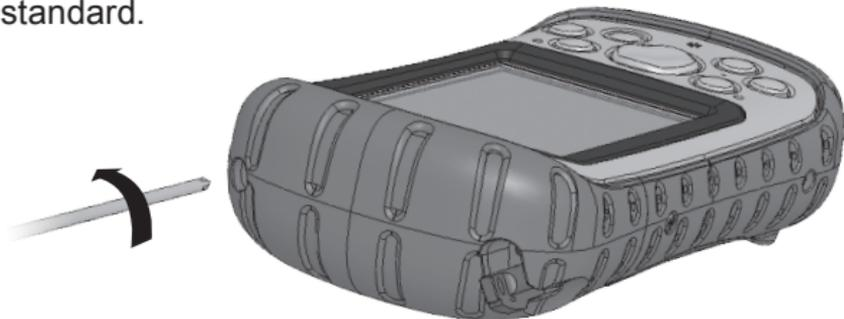
2. Collocare la piastra di adattamento a tenuta sul Field PC con la freccia rivolta verso lo schermo. Serrare le due viti della piastra dell'adattatore.
