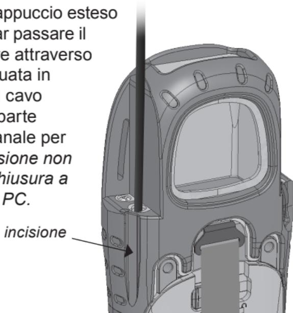
8. Serrare le viti del cappuccio finché sono saldamente in posizione. Per fissare correttamente il cappuccio, applicare un ulteriore  $\frac{1}{4}$  -  $\frac{1}{2}$  giro dopo che le viti diventano difficili da girare.
