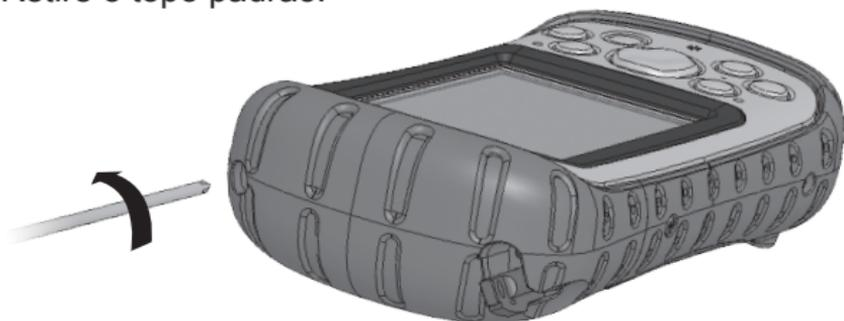
2. Coloque a placa adaptadora de protecção no Field PC com a seta a apontar em direcção ao visor. Aperte os dois parafusos da placa adaptadora.
