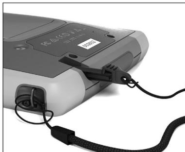
3. Insérez le stylet avec l'attache fixée dans cet anneau et serrez.
