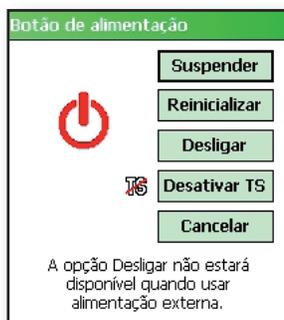
*Nota: A retroiluminação do teclado permanece ligada durante alguns segundos depois de o dispositivo se desligar. Até a retroiluminação do teclado ser desligada, o dispositivo não pode ser novamente ligado.*
