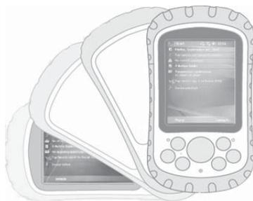
2. Escolha uma das três orientações de ecrã: vertical, horizontal (à direita) ou horizontal (à esquerda). O botão com quatro direcções ajusta automaticamente a orientação do ecrã.
