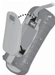
11. Com o fecho da tampa na posição desbloqueada, pressione a tampa da bateria por baixo do fecho e faça deslizar o fecho para a esquerda para o bloquear.
