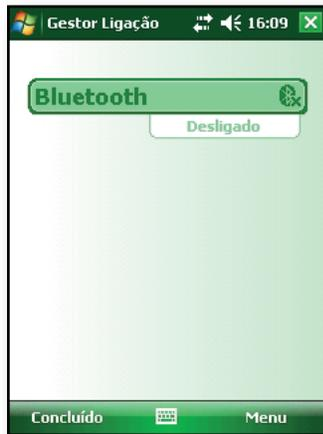
A barra de Bluetooth age como um botão de alternar, permitindo-lhe ligar ou desligar facilmente o dispositivo. Se tornar o dispositivo detectável, o botão de alternar muda entre *Desligado* e *Detectável*. Ao tocar na tecla de função *Concluído*, o ecrã do gestor sem fios fecha-se.
