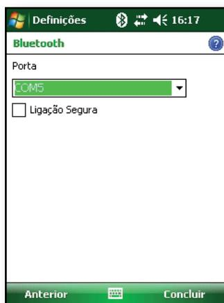
6. **Importante:** Desmarque a opção Ligação segura por baixo da lista de portas COM, conforme é ilustrado acima. Desmarcar esta opção garante que o dispositivo desliga a sua ligação Bluetooth apenas quando assim o pretender.
