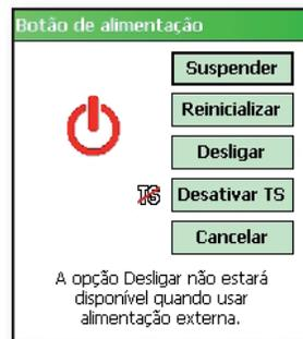
3. Toque em *Desligar*. Surge a caixa de diálogo de aviso, conforme é ilustrado na segunda figura. Toque em *OK*.
