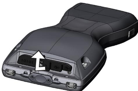
6. Enchufe el cargador de pared en la toma de alimentación del dispositivo Field PC situado en la parte superior de la carcasa. Se abrirá la pantalla Configuración de la carga en la que se solicita que establezca el porcentaje de carga. Seleccione *Introducir porcentaje y capacidad*, establezca la carga de la batería en 10% y deje la capacidad en 4000.
