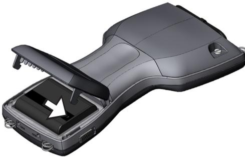
El portapilas de pilas alcalinas se debe utilizar como fuente de alimentación secundaria y de emergencia y no como fuente de alimentación principal. Las pilas duran menos que las baterías estándar y dejan un menor índice de rendimiento. No se podrá activar el calentador de pantalla y se desactivará la retroiluminación cuando se esté por agotar el nivel de energía de la pila.
