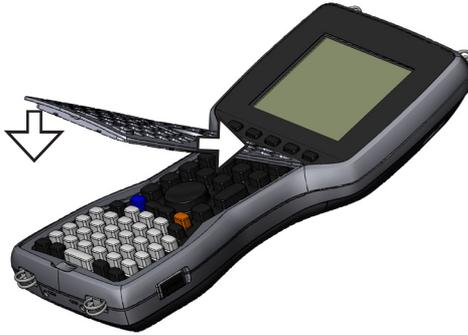
*Nota: tras volver a insertar el bisel, compruebe todas las teclas para asegurarse de que estén libres del bisel. Si alguna parte de una tecla se atrapa debajo del bisel, es posible que no se pueda encender el dispositivo Field PC o que se oiga una secuencia continua de pitidos.*
