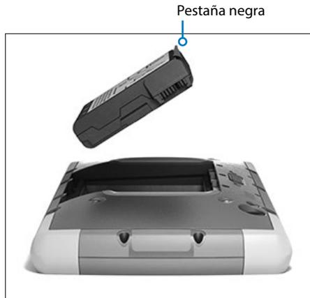
4. Coloque la tapa y presione hasta que el seguro encaje en la posición de bloqueo.
