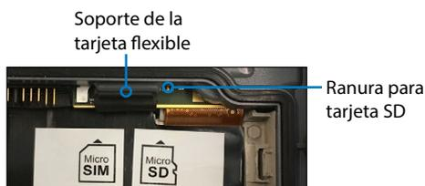
5. Vuelva a colocar el soporte de la tarjeta flexible, cubriendo las ranuras de la tarjeta.
