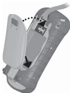
11. Avec le loquet du volet en position déverrouillée, appuyez sur le volet juste en dessous du loquet et glissez le loquet vers la gauche pour le verrouiller.
