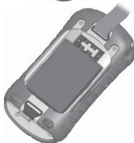
10. Fermez le volet du compartiment de la batterie, en vous assurant que le loquet du volet est dans la position déverrouillée lorsque le volet entre en contact avec le boîtier.
